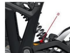
Regolatore del precarico della molla C (ruotare il regolatore in senso orario per aumentare il precarico della molla e in senso antiorario per diminuirlo)
