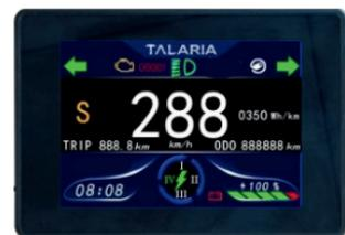
Nell'interfaccia principale, premi SEL UP una volta, Regen+1 livello; tieni premuto SEL UP per azzerare il viaggio a ZERO
