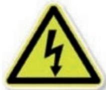
Questo simbolo si trova in vari punti della motocicletta elettrica per avvertirti che la posizione ad alta tensione può causare scosse, ustioni e persino la morte. I componenti ad alta tensione sulla motocicletta elettrica devono essere riparati solo da tecnici con formazione specifica. Il cavo o il cablaggio ad alta tensione ha una copertura arancione. Non sondare, manomettere, tagliare o modificare il cavo o il cablaggio ad alta tensione.
