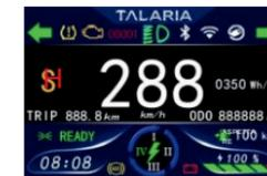
Modalità E:ECO, con potenza in uscita limitata per la massima distanza di guida per carica. È ecologica per i principianti. Modalità S:SPORT, con potenza in uscita costantemente elevata per la guida fuoristrada e sui sentieri. Offrirà ai ciclisti esperti un'esperienza incredibile. Modalità H:HYPER, con potenza in uscita estremamente elevata per una guida da corsa aggressiva. È solo per ciclisti PRO.
